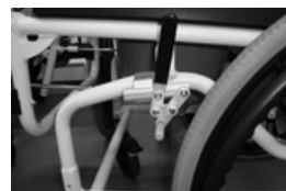
img. 11: fissare il supporto del freno
